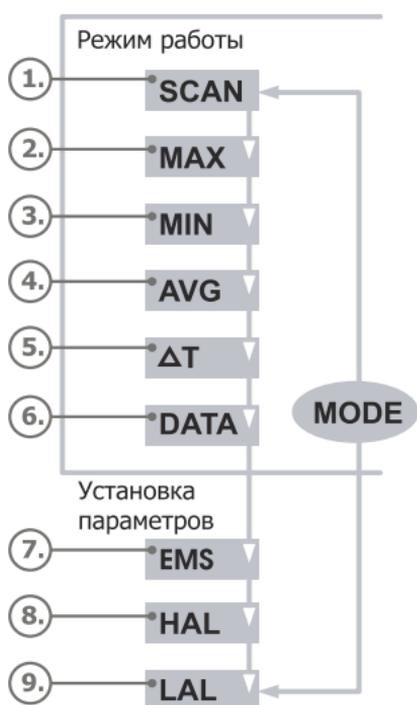
1. Сканирование и отображение температуры в процессе измерения
